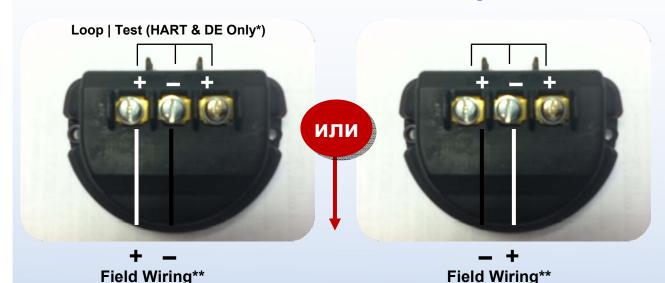
Все типы датчиков (DE, HART, или Foundation Fieldbus) не чувствительны к полярности подключения
